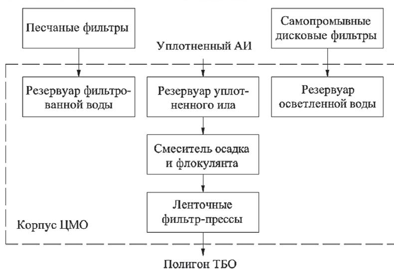
Рис. 1. Технологическая схема корпуса цеха механического обезвоживания:
