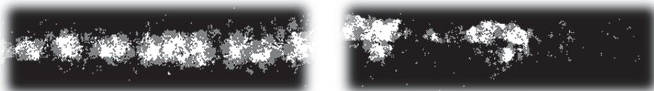
Рисунок 1 – Рентгенограмма сварного шва встык без дефектов и дефектного сварного шва
