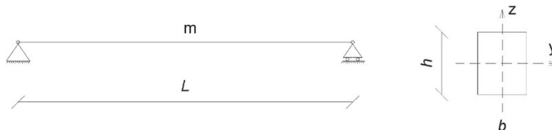
Рисунок 1 – Схема однопролетной балки
