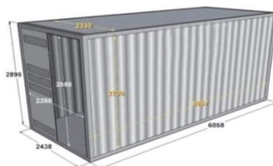
Рисунок 1 – Внешние и внутренние размеры 20-футового контейнера
