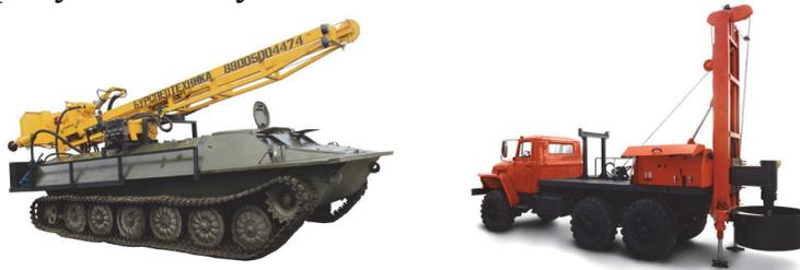
Рисунок 1 – Установки разведочного бурения «УРБ, МБШ, ПБУ»
