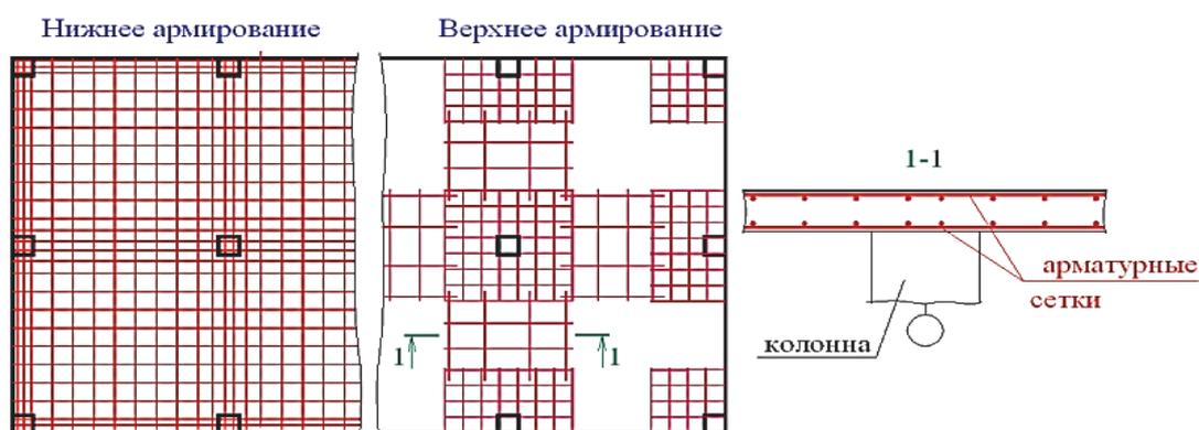
Рисунок 2 - Схема двойного армирования монолитной безбалочной плиты перекрытия
