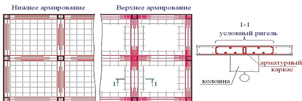
Рисунок 3 - Концентрированное «ригельное» армирование плоских плит пространственными каркасами
