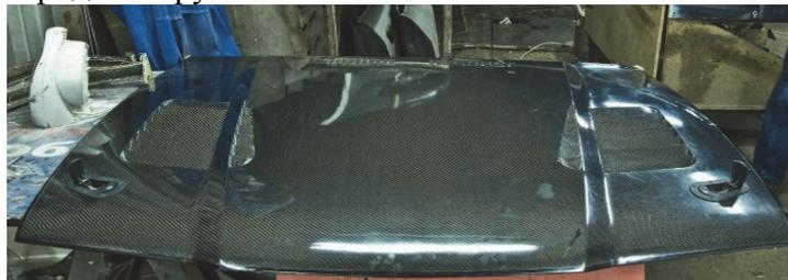
Рисунок 1 – Деталь автомобиля из углеткани
