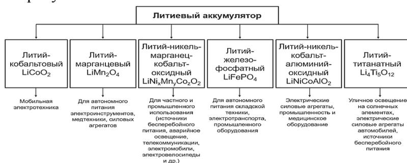
Рисунок 1 – Распространенные виды литиевых аккумуляторов и область их применения
