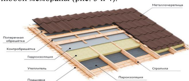
Рисунок 3 – Классическая схема устройства пароизоляции кровли
