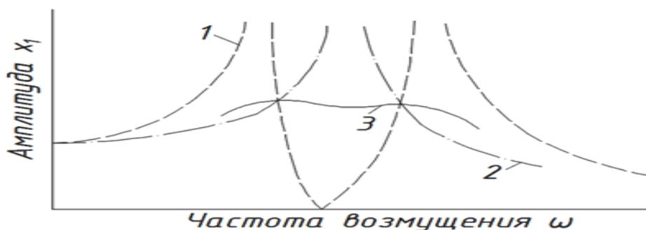
Рисунок 2 - зависимость амплитуды колебания от частоты возмущения
