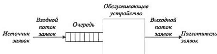
Рисунок 1 - Структура системы массового обслуживания
