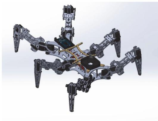
Рисунок 2 – 3D-модель корпуса робота
