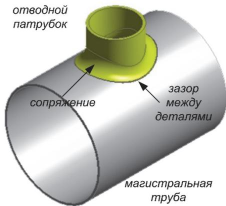
Рисунок 1 – Магистральная труба и отводной патрубков
