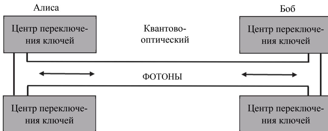
Рисунок 1 – Квантово-криптографическая схема
