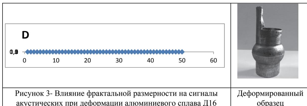
Полученные результаты говорят, что перед разрушением конструкционного материала фрактальная размерность уменьшется и происходит разрушения образца, то есть не происходит пластического деформирования материала. Если деформирование заготовки происходит при большом количестве сигналов, что отражает активное перестроение структуры материала, получаемая деталь формируется в соответствии с проектом.
