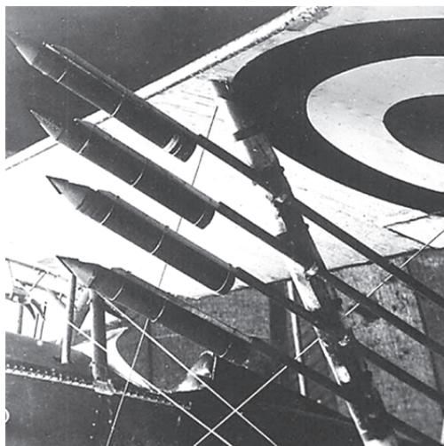
Рисунок 1 – Крепление ракет Le Prieur к стойке крыла истребителя Nieuport N.21
