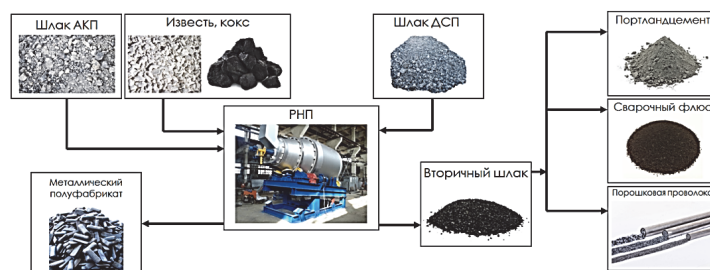
Рисунок 3 – Схема безотходной переработки ковшевого и электропечного шлака
