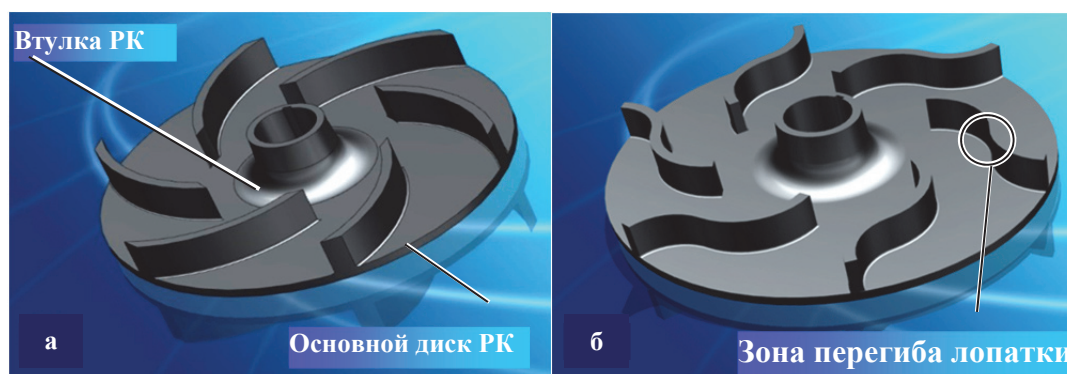
Рисунок 1 – Варианты рабочего колеса МЦН с 2-мя типами лопаток а – цилиндрические лопатки, б – S-образные лопатки
