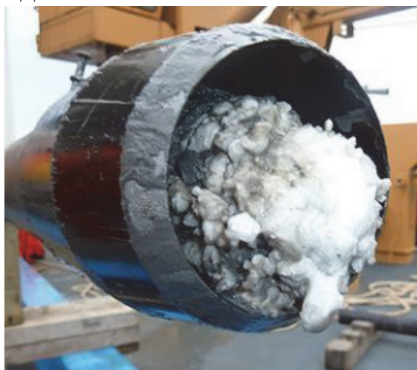
Рисунок 2 - Образование гидратов в технологических трубопроводах
