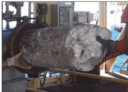
Рисунок 2 - Образование гидратов в технологических трубопроводах
