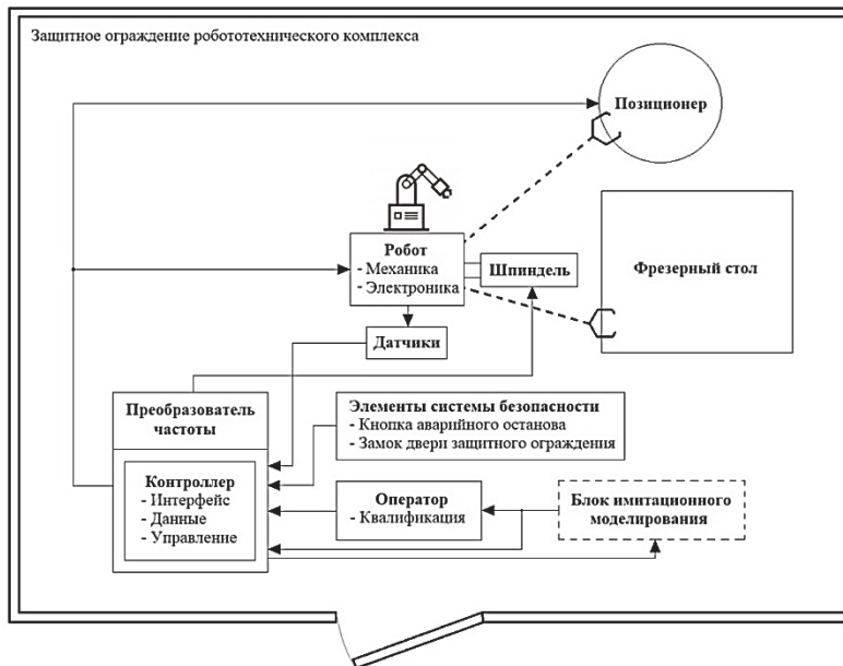
Рисунок 1 – Структурная схема роботизированного технологического комплекса механической обработки
