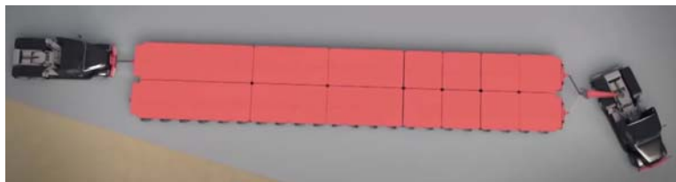
Рисунок 1 – Транспортировочный модуль для карьерного самосвала
