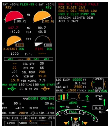
Рисунок 2 – Пример индикации формата EWD гражданского самолёта MC-21
