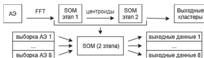
Рисунок 1 – Схема обработки выборок зарегистрированных сигналов АЭ
