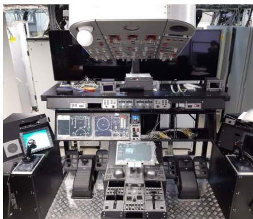
Рисунок 3 – Стенд интеграции авионики с установленной на камерой (выделена красным цветом)
