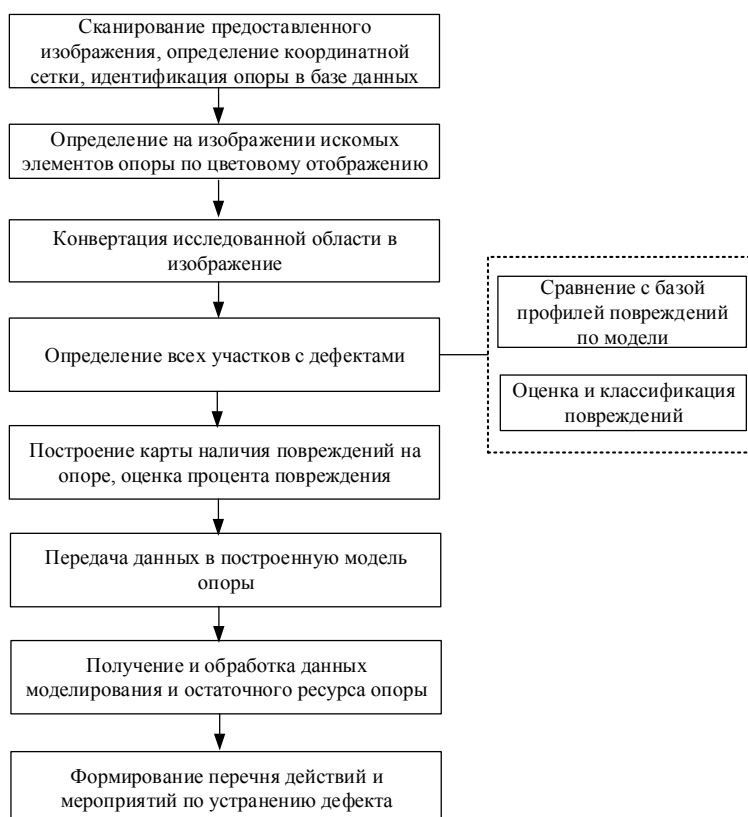
Рисунок 2 – Порядок проведения обработки результатов диагностических обследований
