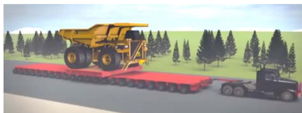
Рисунок 2 – Транспортировка карьерного самосвала
