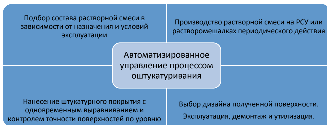
Рисунок 2 - Схема автоматизированного управления жизненным циклом процесса оштукатуривания
