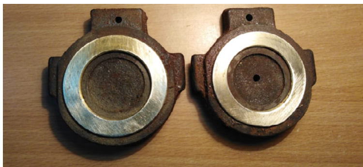
Рисунок 1 – Элементы шиберной задвижки, учитываемые при расчете момента сопротивления
