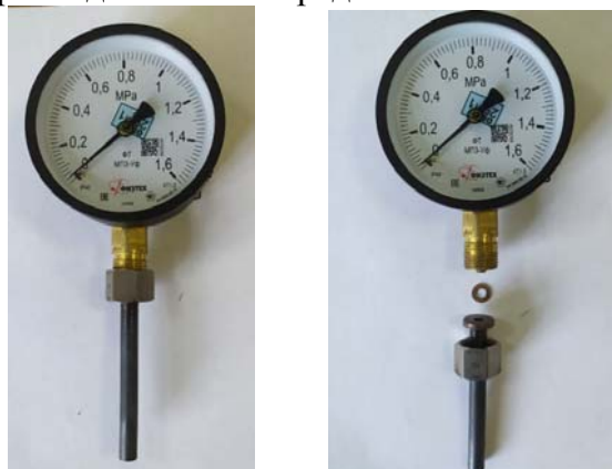
Рисунок 2 – Схема соединения капсулы с манометром
